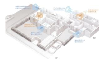
機密・断熱パッキンによるSWパネルの高気密施工で、優れた遮音性能を發揮。さらには、断熱サッシが、遮音性能を一層高めます。
