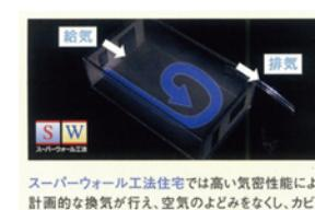
スパーワーク工法住宅では高い気密性能により計画的な換気が行き、空気のよどみをなくし、カビやダニの発生を抑えます。
