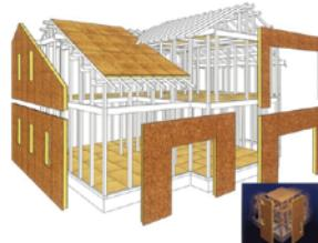
SW工法は、ジャンボジェット機にも用いられる高耐震のモノコック構造。台風や地震などの外力が接合部などに集中しにくく建物全体に分散するため、ひずみやくるいに強さを発揮します。
